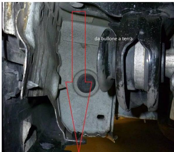
N.B. In deroga a quanto stabilito precedentemente, i bulloni di fissaggio dei bracci oscillanti delle sospensioni posteriori (cat. 33 30 6 770 527) non sono liberi.
